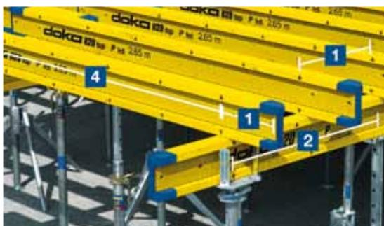
1-2-4 - это максимальные расстояния для сборки элементов DokaFlex 1-2-4. Треугольные метки на балках выполняют функцию интегрированной измерительной ленты для перекрытий толщиной до 30 см.
